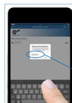
Bei Passwortabfrage nutzen Sie die letzten 6 Ziffern der ID-Nummer auf dem Typenschild des NORDAC ACCESS BT und koppeln Sie die Geräte. Sobald die Geräte verbunden sind, leuchtet die Bluetooth-LED dauerhaft blau.
