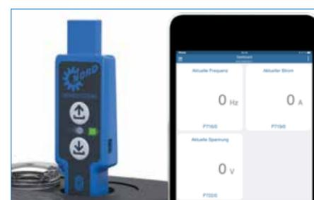
Das Dashboard erscheint und die Bluetooth-LED leuchtet blau. Der NORDAC ACCESS BT ist nun mit dem Endgerät verbunden.
